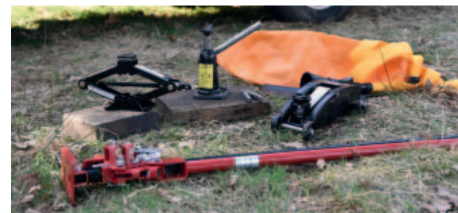
Testgeräte (v. l. M): Scherenwagenheber, Hydraulischer Wagenheber, Rangierwagenheber; High Lift (Vordergrund), Ballonwagenheber (Hintergrund).
