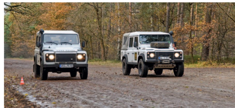
Beide Wagen beschleunigten auf 60 km/h, dann traten die Fahrer auf die Bremsen.
